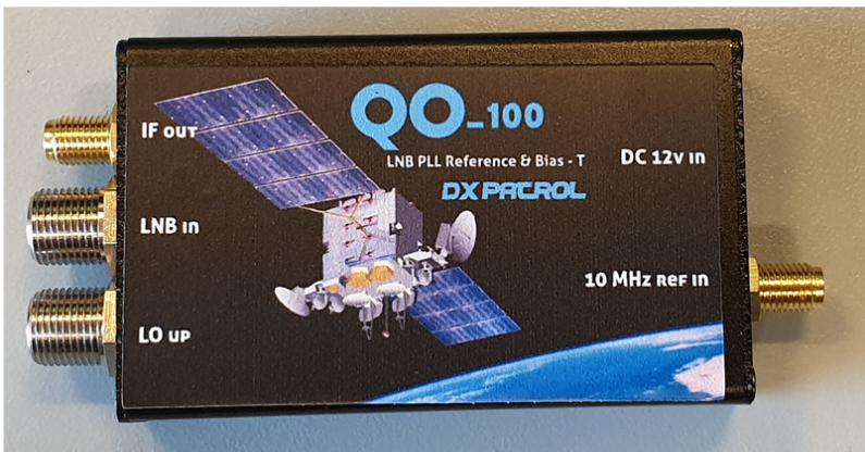
De oscillator in zijn kastje, 75 x 45 x 20mm (l x b x h).
